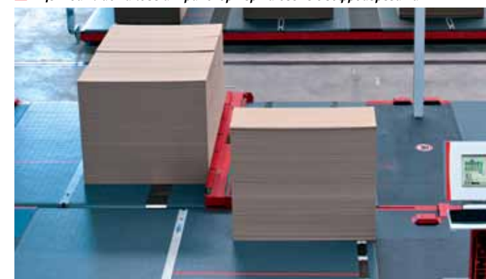
▲ Оптимизация в поперечном направлении: одновременная передача двух блоков на одну тележку
