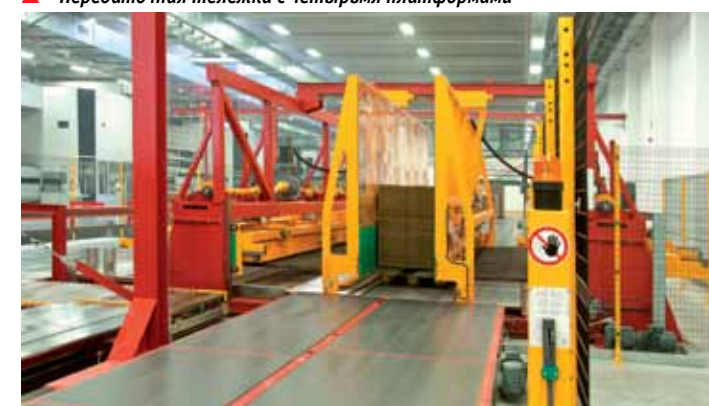
▲ Двойная станция загрузки на паллеты для 200 загрузок/ч
