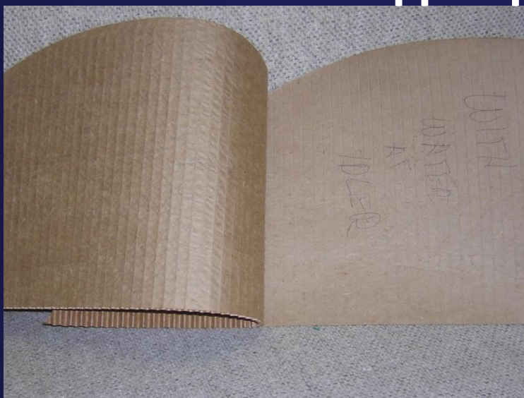
С увлажнителем Water Deck, отслаивание
