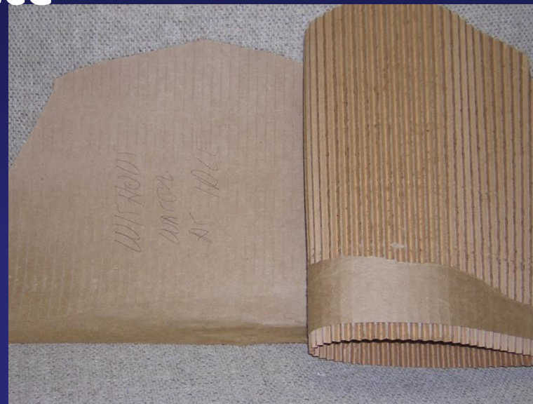
Без увлажнителя Water Deck, отделение лайнера от флютинга
